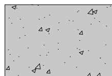
Lastra di calcestruzzo
